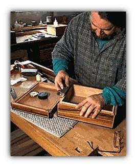
Für das Lining verwenden Sie am besten 4mm starkes Alone-Holz Furnier. Die Einpaßarbeit für das Lining ist handwerklich nicht schwierig, da wir die Alone-Platten bereits mit einer gefrästen Fase ausliefern und damit das aufwändige "Anhobeln" entfällt. Allerdings muß hier dennoch sorgfältig gearbeitet werden, da das Lining für die Schließung des Humidors verantwortlich ist und damit entscheidend das Klima bzw. die Luftzirkulation beeinflußt.
