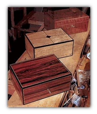
Es bleibt natürlich Ihnen überlassen, welche Oberfläche Sie wählen. Ölen, wachsen, matt lackieren, Hochglanz lackieren – alles geht. Zum lackieren legen Sie ein Stück Papier auf die Oberkante des Lining so dass der Humidor nicht ganz schließt.
