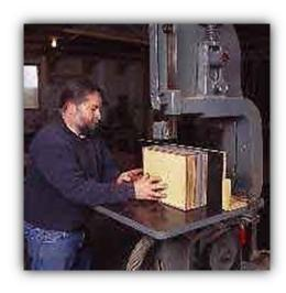
die Sägenut. So verfahren Sie rundherum, bis Sie den Deckel abgetrennt haben. Es liegen nun zwei exakt zueinander passende Teile vor Ihnen – der Humidor läßt sich erahnen. Nun werden die Quadrantscharniere und das Schloß eingepaßt.
